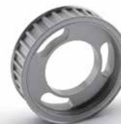
Eindrehung und Langlöcher zur Massereduzierung und Positionsausrichtung
